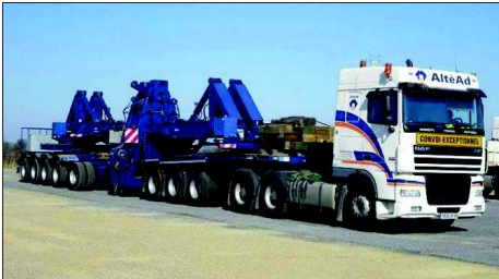
Photo 16 : Exemple de camion assurant le transport des composants d'un parc éolien
